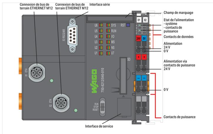
Le contrôleur PFC200 est un automate compact de la gamme WAGO I/O System. En plus des interfaces réseau et de bus de terrain, il supporte les bornes d'entrées/sorties digitales, d'entrées/sorties digitales analogiques et spécifiques des séries 750/753. Les deux interfaces ETHERNET et la connexion « Switch » intégrée permettent le câblage dans une topologie en ligne.
