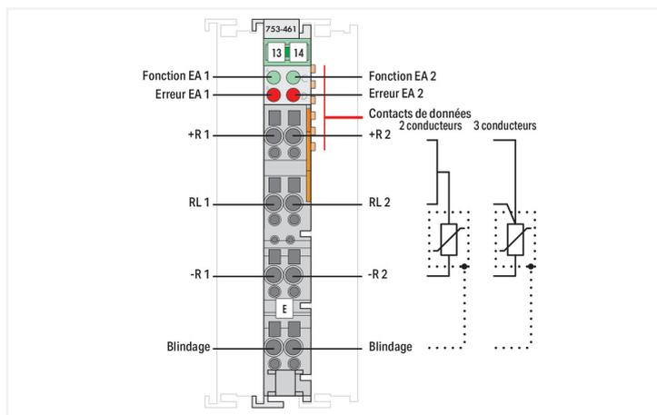
La borne d'entrées analogiques permet une connexion directe de sondes de température Pt ou Ni.
