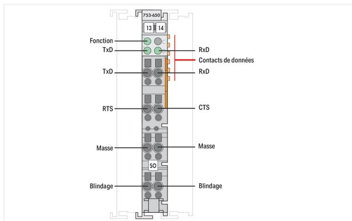
L'interface intégrée dans la borne de bus permet la connexion d'appareils avec une interface RS-232-C.
