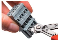
Codage d'un connecteur femelle – Enlever la(les) tige(s) de codage à l'aide d'un outil coupant Ni la 1<sup>ère</sup> ni la dernière tige de codage, elles servent à la fixation.
