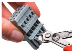
Codage d'un connecteur femelle – Enlever la(les) tige(s) de codage à l'aide d'un outil coupant. Ni la 1ère ni la dernière tige de codage, elles servent à la fixation.
