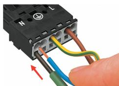
Actionner le ressort de serrage à l'aide d'un outil de manipulation dont la largeur de lame est de 2,5 mm et introduire le fil dénudé jusqu'en butée pour raccorder des conducteurs souples.
