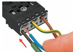
Actionner le ressort de serrage à l'aide d'un outil de manipulation dont la largeur de lame est de 2,5 mm et introduire le fil dénudé jusqu'en butée pour raccorder des conducteurs souples.
