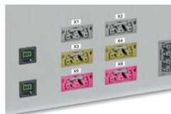
Dans le codage B, des connecteurs de couleur différente ont une compatibilité d'enfichage entre eux. A observer absolument: Il existe une identification des différents circuits par la couleur et/ou les différents marquages de pôles. On ne peut connecter que des connecteurs de la même couleur et marqués de la même manière.
