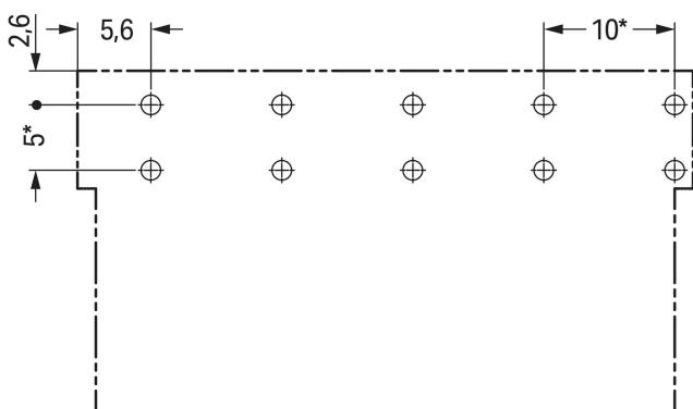
Diamètre de perçage : 1,5<sup>+0,1</sup> mm
