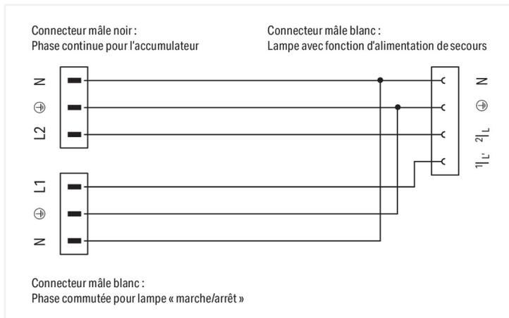
Ce câble, prévu pour se raccorder à une lampe, est doublé pour se raccorder en parallèle à une alimentation de secours (AkkuPack). La phase continue de l'accumulateur est menée par le connecteur mâle noir à 3 pôles tandis que la phase commutée de la lampe («marche/arrêt») par le connecteur mâle blanc à 3 pôles.
