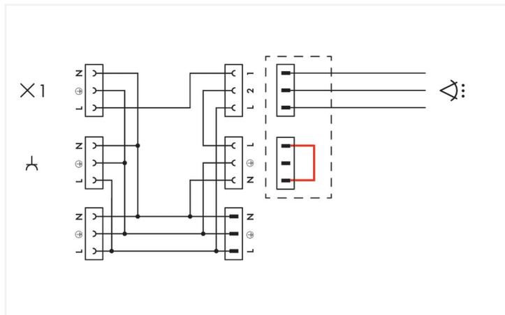
Le câble de branchement est une combinaison d'un câble de branchement habituel ; codage S, et d'un connecteur SHUNT, codage A. Les deux boîtiers de décharge de traction sont reliés entre eux de manière fixe. Lors de l'utilisation du câble de branchement avec le distributeur 770-637, on peut directement connecter soit un détecteur de mouvement, soit un commutateur avec lampe de contrôle.
