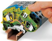
Les bornes de protection peuvent être pontées dans un sens à l'aide des contacts de pontage (par-dessus la paroi arrière de la borne) avec des bornes de passage. En plus du repérage nécessaire pour ces bornes, nous recommandons l'utilisation de contacts de pontage jaune-vert.
