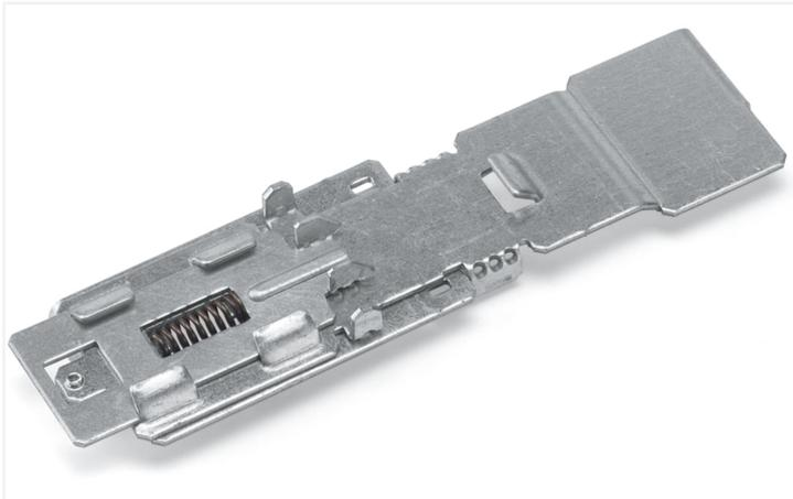
L'adaptateur pour rails (787-896) peut être utilisé pour un montage vertical ou horizontal des appareils 787-8xx. Fixer l'adaptateur pour rail (787-896) à l'appareil en insérant les deux éléments individuels dans les rainures de guidage du dissipateur puis visser. On peut ainsi facilement modifier la position.
