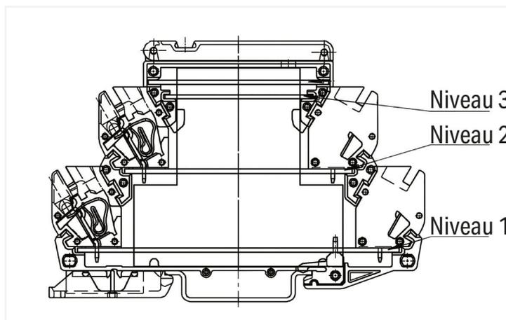
Boîtier électronique universel modulaire aux dimensions des bornes sur rail - boîtier 55 mm
