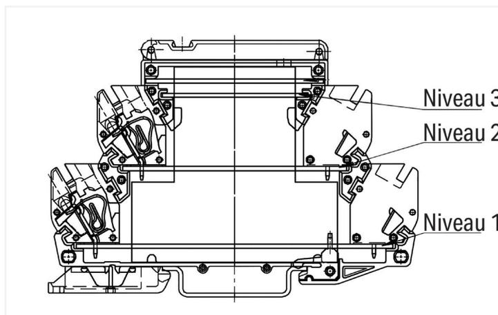
Boîtier électronique universel modulaire aux dimensions des bornes sur rail - couvercle 55 mm
