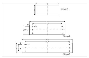
Dimensions des circuits imprimés, pour montage vertical : (épaisseur de circuits imprimés max. 1,5 mm) dans le niveau 1;
