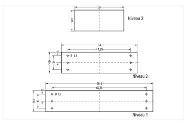
Dimensions des circuits imprimés, pour montage vertical : (épaisseur de circuits imprimés max. 1,5 mm) dans le niveau 1;
