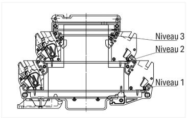
Boîtier électronique universel modulaire aux dimensions des bornes sur rail - curseur de desserrage
