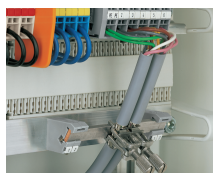
Supports isolés permettant une mise à la terre de blindage, indépendante du potentiel du boîtier
