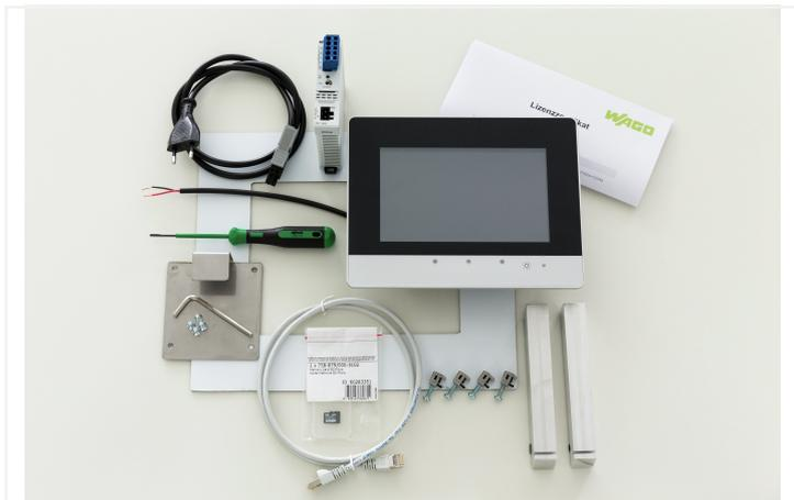
Le kit de démarrage Touch Panel 600 contient un Advanced Control Panel de 17,8 cm (7,0") avec une licence complète à utilisateur unique du logiciel d'ingénierie **e!COCKPIT** (basé sur CODESYS V3).
