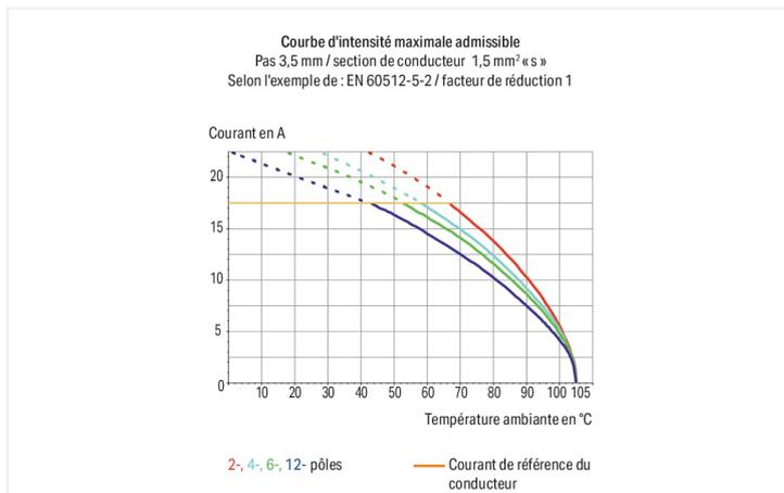
Borne pour circuits imprimés série 805 avec introduction du conducteur vers la platine de 0 °
