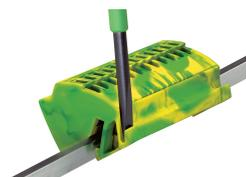
Démontage du bloc de barres collectrices de mise à la terre par déverrouillage de la face gauche et droite du bloc. Ensuite, enlever le bloc en le tirant vers le haut.
