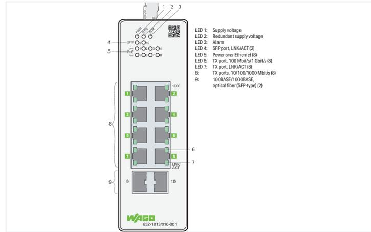
Le switch 852-1813/010-001 est un switch industriel ETHERNET administrable avec 8 ports 10/100/1000Base-T qui supportent tous l'alimentation par Ethernet "Power over Ethernet" (PoE+) de 30W et 2 slots pour adaptateur SFP 100BASE-FX/1000BASE-LX/SX/ZX (les modules SFP sont disponibles sur demande).
