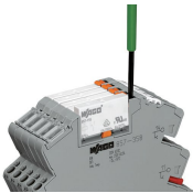
Manipulation du levier de démontage du relais
