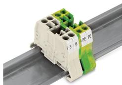
Pour respecter les distances d'isolement des lignes de fuite exigées dans le domaine Ex e, il faut toujours monter une plaque d'extrémité ou intermédiaire entre une borne de passage et une borne de protection.
