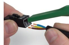
Pour le raccordement des conducteurs souples, ouvrir tous les ressorts de serrage à l'aide de l'outil de manipulation 890-383 et introduire le fil dénudé jusqu'en butée. La connexion des câbles rigides se réalise par insertion directe.
