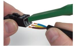
Pour le raccordement des conducteurs souples, ouvrir tous les ressorts de serrage à l'aide de l'outil de manipulation 890-383 et introduire le fil dénudé jusqu'en butée. La connexion des câbles rigides se réalise par insertion directe.
