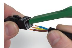
Pour le raccordement des conducteurs souples, ouvrir tous les ressorts de serrage à l'aide de l'outil de manipulation 890-383 et introduire le fil dénudé jusqu'en butée. La connexion des câbles rigides se réalise par insertion directe.
