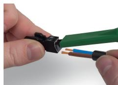
Pour le raccordement des conducteurs souples, ouvrir les deux ressorts de serrage à l'aide de l'outil de manipulation 890-383 et introduire le fil dénudé jusqu'en butée. La connexion des câbles rigides se réalise par insertion directe.
