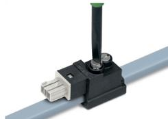
Contact avec le câble plat par serrage des vis. Merci d'observer le couple de serrage de 1 Nm !
