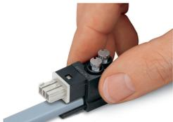
Le montage du module IDC sur la partie inférieure est seulement possible, si le codage est approprié. Si le détrompage de la partie inférieure du module bloque son montage, il faut tourner la partie supérieure de 180° et le monter de nouveau.
