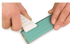
Ouvrir la gaine du câble plat à l'aide d'un couteau de dégainage sur les deux côtés (longueur de dégainage 30 mm).
