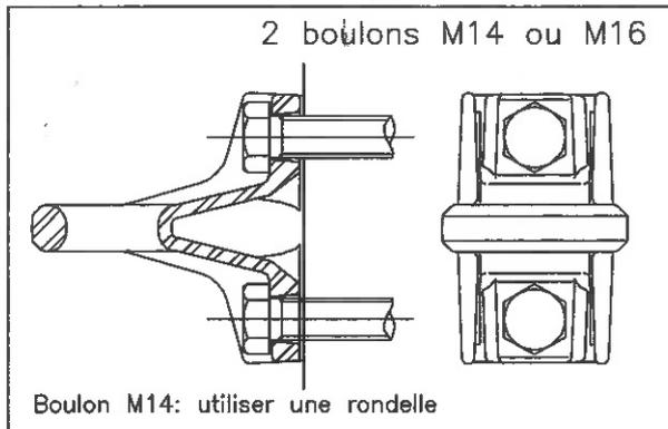
Fixation console d'ancrage – Par feuillards
