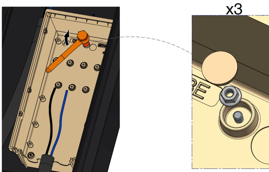
4) Positionner les gaines sur les ouvertures selon les configurations ci-dessous.
