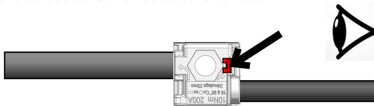
3 - **Serrer** l'embout jusqu'à rupture de la tête fusible tout en le maintenant fermement à l'aide d'un outil adapté. Pour les serrages suivants, utiliser un Hc6 et serrer à 10Nm.
