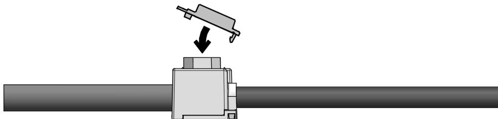
6 - **Raccorder** l'embout dans le bornier du distributeur S35 => Voir notice du distributeur.
