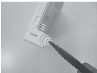
A l'aide d'une pince, ouvrir les prédécoupes nécessaires sur le capot pour laisser passer le câble de distribution.
