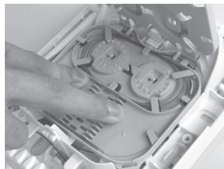
Remonter le cache en glissant les languettes sous les crochets.
