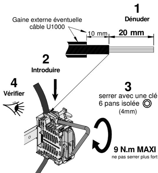
**3 - Mise en place de l'élément fusible ou neutre :**
