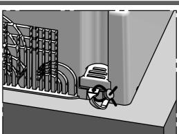
4 Réaliser le scellé (non fourni) sur le cache-vis.
