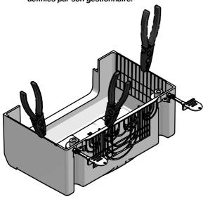
**Préparer** le boitier en découpant les entrées de câbles au plus près avec une pince ou un couteau pour garantir l'indice de protection (IP).
