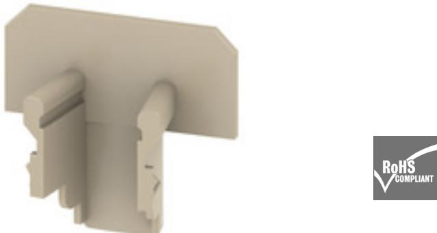
Une séparation est utilisée pour la séparation optique de circuits ou pour l'isolation électrique des connexions transversales adjacentes. Contrairement au flasque de fermeture, le contour peut être plus grand que les blocs de jonction adjacents. Toutefois, il ne devrait pas être plus petit, sinon les distances de dégagement et de fluage requises à l'intérieur de l'application ne peuvent plus être maintenues.
