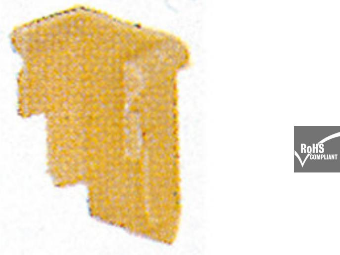
Une séparation est utilisée pour la séparation optique de circuits ou pour l'isolation électrique des connexions transversales adjacentes. Contrairement au flasque de fermeture, le contour peut être plus grand que les blocs de jonction adjacents. Toutefois, il ne devrait pas être plus petit, sinon les distances de dégagement et de fluage requises à l'intérieur de l'application ne peuvent plus être maintenues.
