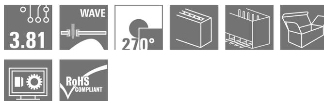
Le connecteur mâle SC à orientation de sortie de 270° - l'angle de 270° est défini entre le sens d'enchâssement et les picots à souder, et définit un sens d'enchâssement parallèle au circuit imprimé, mais pour l'enchâssement de connecteurs femelles sur tête.
