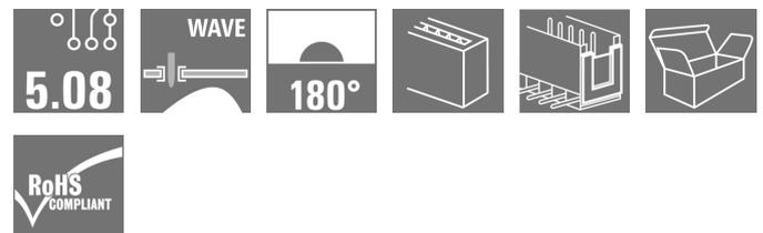
Connecteurs mâles droits et stables dimensionnellement. Ils peuvent être codés grâce au détrompage intégré de la famille Unimate Range. Ils sont disponibles en version ouverte ou fermée latéralement. Dans la version fermée possibilité d'ajouter des blocs de fixation. La longueur des picots de 3,2 mm est optimisée pour la soudure à la vague. Conditionnés dans un emballage carton.
