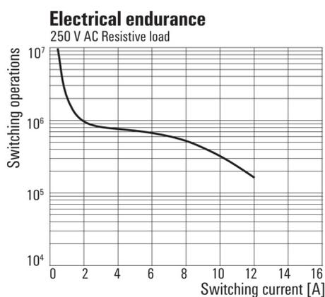
Durée de vie électrique 250 V AC resistive load
