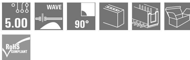
Connecteurs mâles avec sortie à 90°. La longueur des picots est optimisée pour la soudure à la vague. Ils peuvent être repérés et codés.
