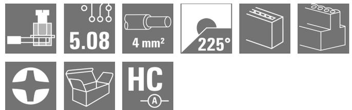
Connexion à étrier pour raccordement de fil à la perpendiculaire (90°/270°) ou coudé (225°). Les connecteurs femelle disposent d'espace pour les marquages et peuvent être codés. Fixation par bride ou par levier de verrouillage. Ils disposent également d'une vis plus/moins intégrée et d'une protection contre toute mauvaise insertion du connecteur. Ils sont livrés avec étriers ouverts. HC = Courant fort.
