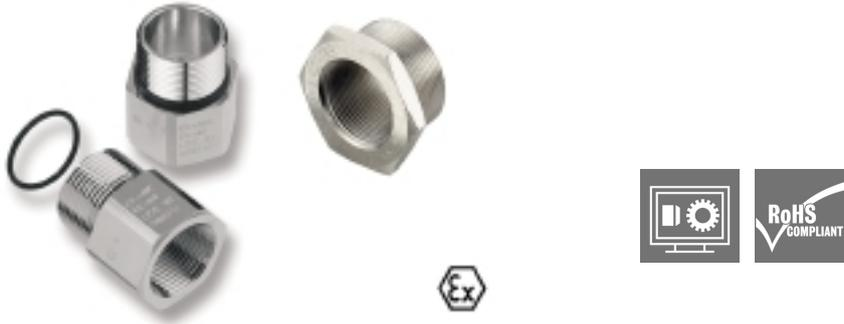
Les adaptateurs de la série ADAP offrent flexibilité et polyvalence en remplissant les entrées inutilisées des équipements Ex, tout en maintenant une protection antidéflagrante Ex d, une protection contre les explosions Ex e à sécurité accrue et un indice de protection IP66/67/68.
