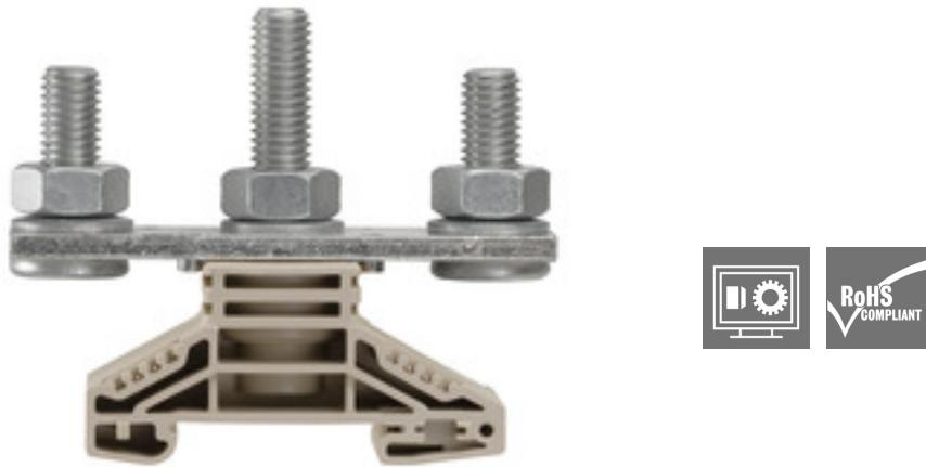
La large gamme de blocs de jonction à tige garantit un raccordement sûr dans toutes les applications de transmission de puissance. Les raccordements vont de 10 mm<sup>2</sup> à 300 mm<sup>2</sup>. Les connecteurs sont fixés aux broches filetées à l'aide de cosses serrées et chaque connexion est sécurisée en serrant l'écrou hexagonal. Les blocs de jonction à tige avec broches filetées de M5 à M16 peuvent être utilisés selon la section du conducteur.
