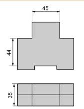
DD adapté pour la coupure du circuit aux dimensions indiquées dans le schéma (d'après la norme DIN 43880).
