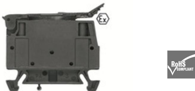
Dans certaines applications il est utile de protéger les liaisons d'alimentation avec un fusible séparé. Les blocs de jonction à fusible sont constitués en partie inférieure d'une barrette de raccordement avec un support d'insertion de fusibles. Les fusibles varient du levier pivotant et du support de fusibles enfichable au système vissable et au fusible enfichable plat.
