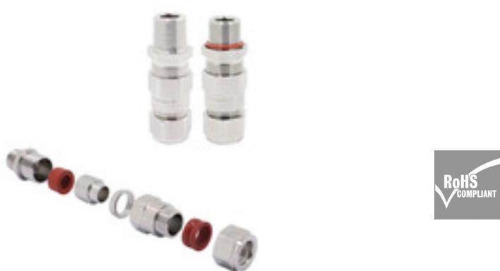
Les presse-étoupes de type E1W conviennent aux câbles armés en acier SWA. Ils maintiennent une protection antidiéflagrante Ex d et une protection contre les explosions Ex e à sécurité accrue. Le serrage de l'armure assure en outre une liaison électrique entre l'armure du câble et les presse-étoupes.
