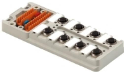
Les répartiteurs M12 sont proposés dans de très nombreuses versions. Les 4, 6 ou 8 connecteurs M12 disposent de 4 ou 5 pôles. La sortie principale se présente sous forme de câble fixe, de capot à raccorder soi-même ou de M23. Il existe par ailleurs d'autres versions particulières. Il existe par exemple un répartiteur 1 : 1 permettant de choisir librement le raccordement ou des répartiteurs homologués Ex Zone 1.
