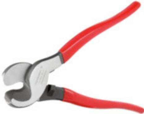
Outils à couper pour conducteurs jusqu'à 8 mm, 12 mm, 14 mm et 22 mm de diamètre extérieur. La géométrie de coupe spéciale assure une coupe nette et sans écrasement des conducteurs en cuivre et aluminium avec un effort physique minimum. En outre, les outils de coupe (KT 8 à KT 22) sont munis d'une protection isolante testée VDE et GS jusqu'à 1 000 V, conformément aux normes EN/CEI 60900.
